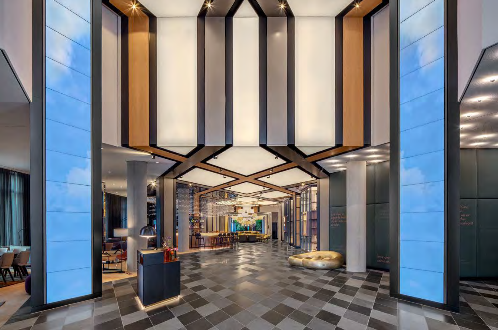
Abb.: In der Lobby sorgen LED-Spanndecken für die Grundbeleuchtung, drei Lichtszenen passen sich in der Helligkeit den Tageszeiten an. Die Video-Screens zeigen den Münchner Himmel, eine Arbeit des Künstlers Yves Peitzner.
